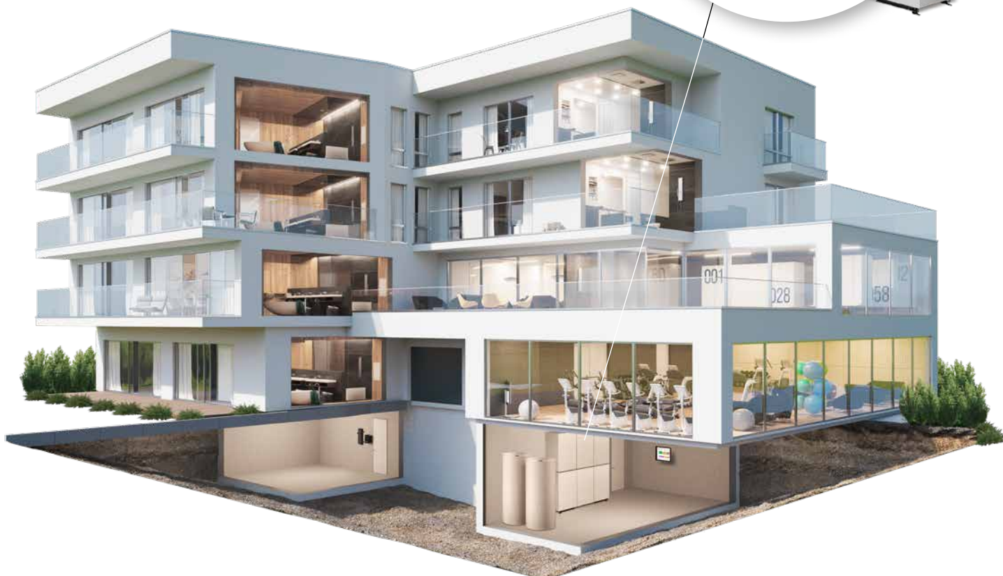
Compress 7000 LW: verwarming, warm water en koeling voor middelgrote en grote gebouwen, van 22 tot 400 kW met hoge COP- en SCOP.
